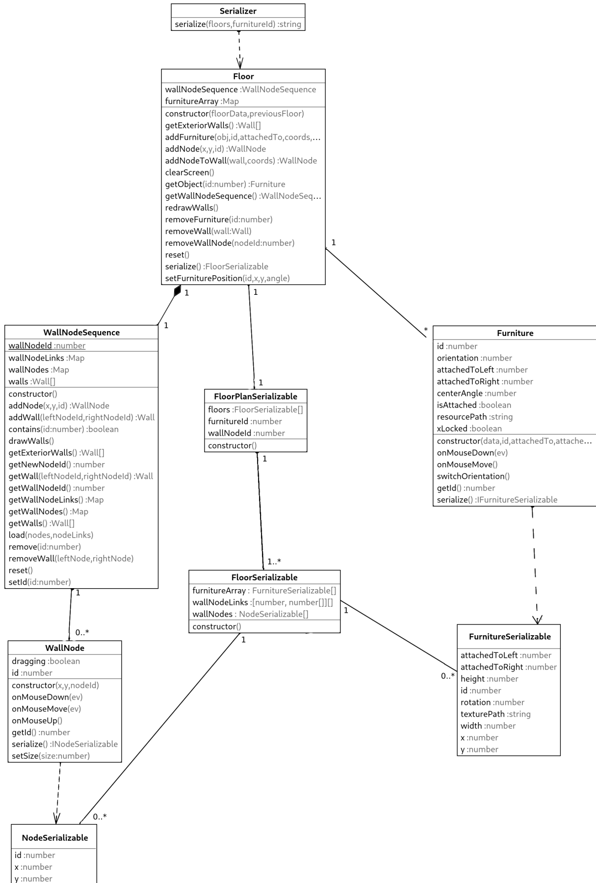
Figura 3.9: Diagrama UML a claselor principale ale modului de serializare
